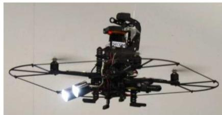
図66-36 小型飛行監視ロボット( /セコム)
