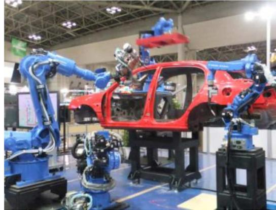
図66-15 アーク溶接ロボット (安川電機)
