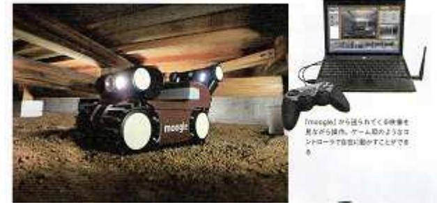
床下点検ロボ / 大和ハウス工業
