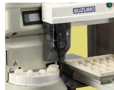
図66-28 小型シャリ玉ロボット (鈴茂器工)
