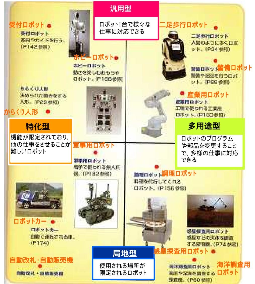
図66-7 ロボットの種類と用途
