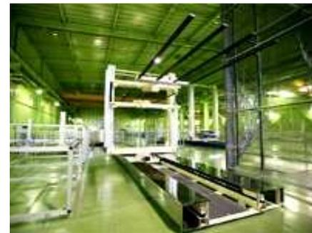
図66-18 ガラス基板搬送用ロボット (平田機工)
