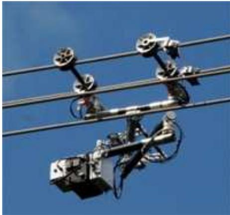
超高压送電線の活線点検ロボット / 第4回ロボット大賞 - 中小企業基盤整備機構理事長賞
