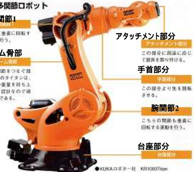
図166-14 産業用ロボットの仕組み
