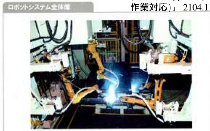
協調ロボット溶接システム / 神戸製鋼所
