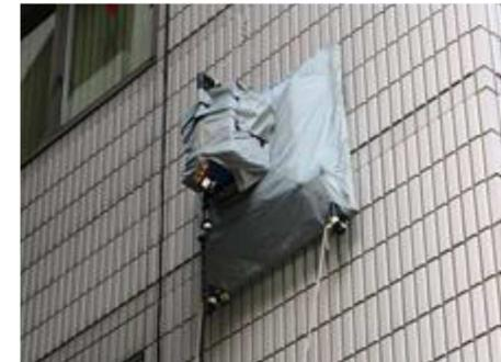
図66-34 壁のタイル検査ロボット(東急建設)
