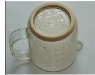
図64-15 PC製カップの劣化
