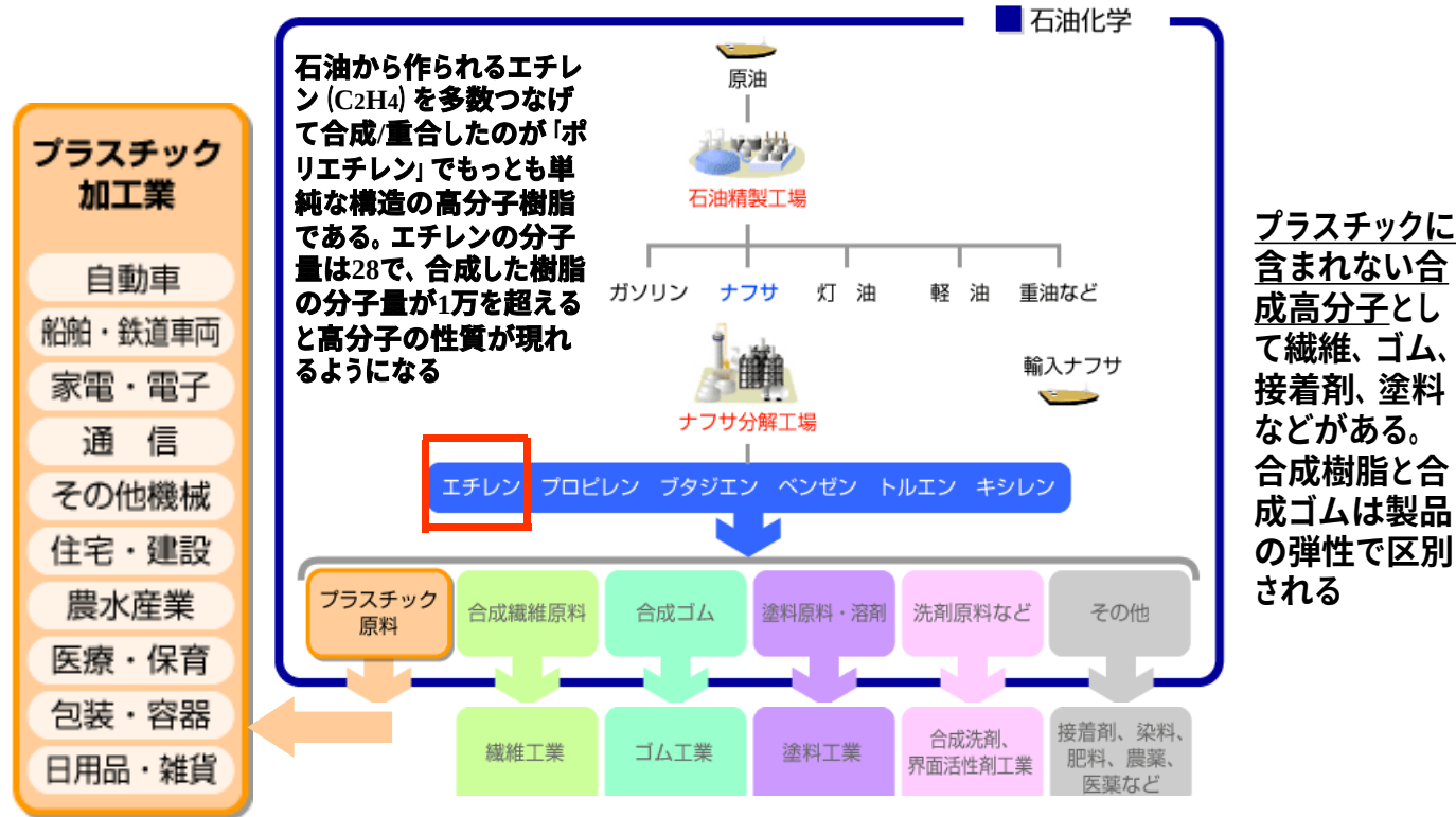
図64-1 原油から製品までのフロー
