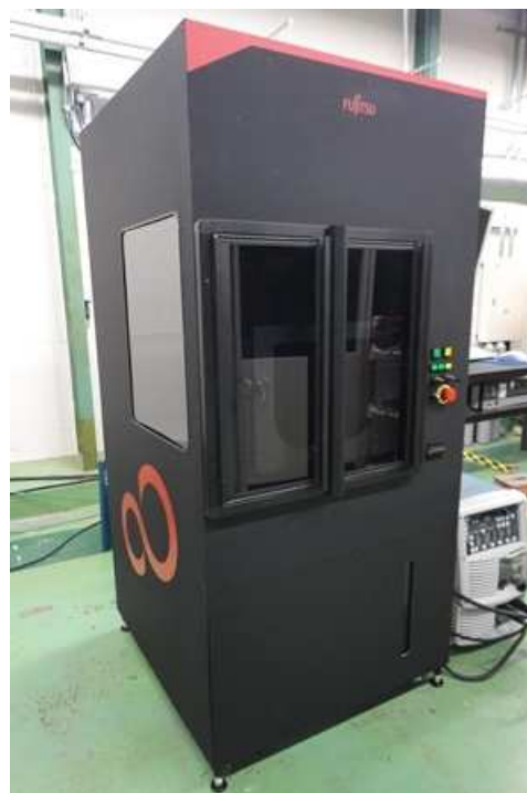
図62-26 溶融金属積層方式金属3Dプリンタの開発 (富士通アイソテック／Web)
