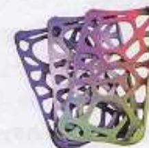
図1●樹脂のフルカラー造形 樹脂粉末に対して、3色のバイ
