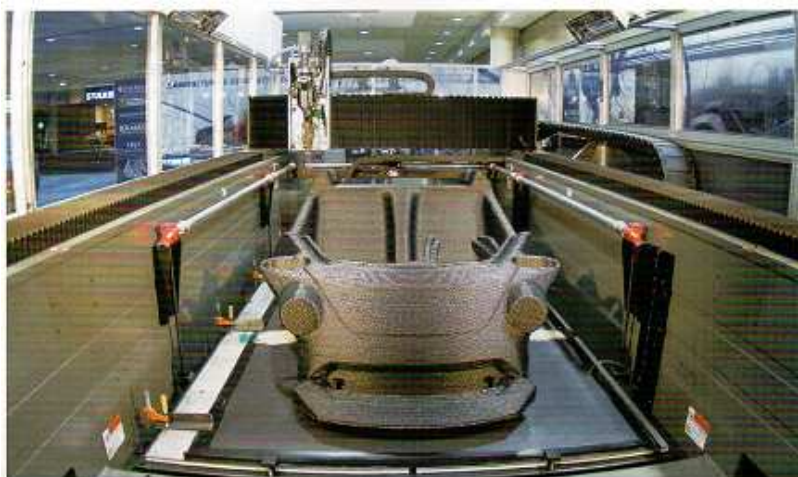
● 図62-32 3D-Pによる自動車ボディの製作 (日経ものづくり 2015年3月)
