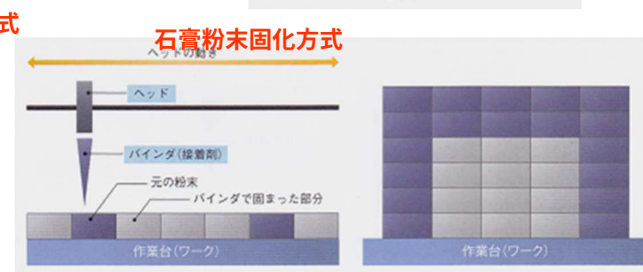
図62-17 各種出力方式の模式図 ⑩
