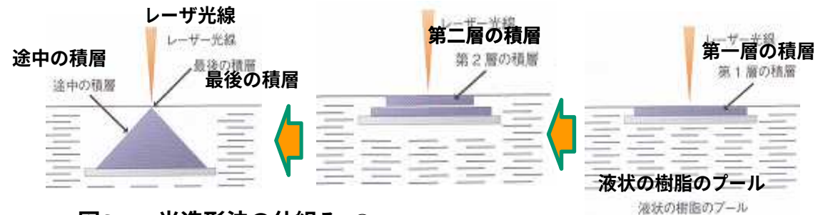
図62-2 光造形法の仕組み ⑩
