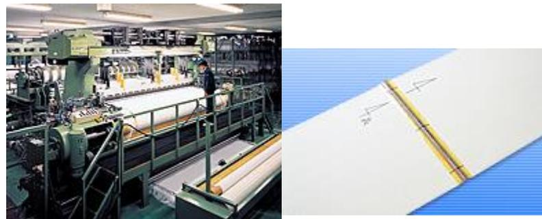
図51-8 ろ布織機とベルトプレス用ろ布 (中尾フィルタ)
