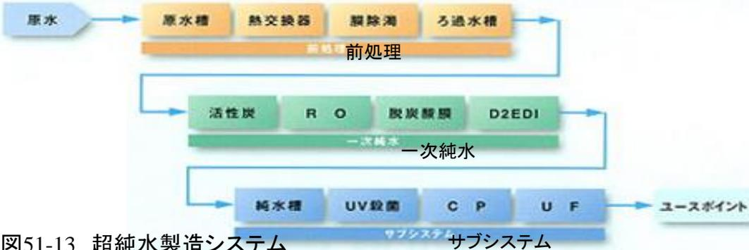
図51-13 超純水製造システムフローの例 (オルガノ)
