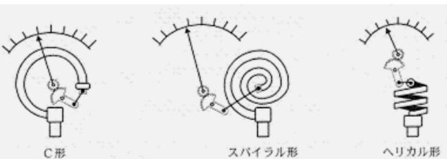
図41-23 ブルドン管圧力計の仕組み ②
