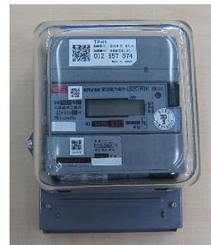
図40-9 「新計量システム」の新型メーター(関西電力が導入中)
