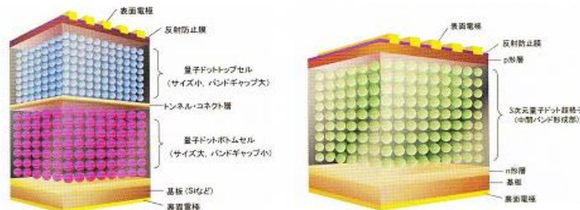
量子ドット太陽電池の構造概念図 (左: タンデム太陽電池, 右: 超格子太陽電池)
