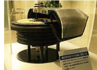
図35-28 新幹線N700系用の空気ばね (カットモデル) (エーエス)
