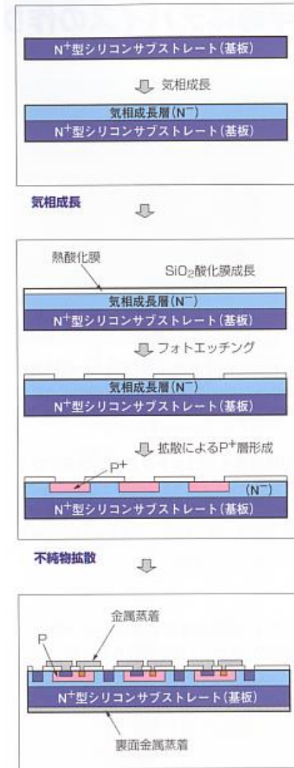
配線、電極金属の蒸着
