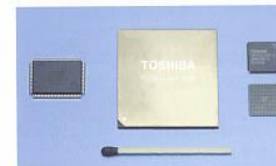
ロジックIC 汎用ロジックIC、マイクロプロセッサ、他
