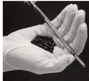
図31-35 核燃料ペレットと燃料被覆管
