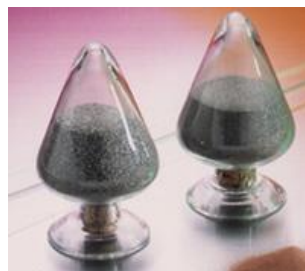
図31-10 Ti-Cr-Mn合金を使ったトヨタ自動車の水素貯蔵タンク (80kgのタンク1本に2Kg以上の水素を貯蔵。350気圧で水素を充填)
