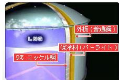
図31-6 LNGタンクの構造
