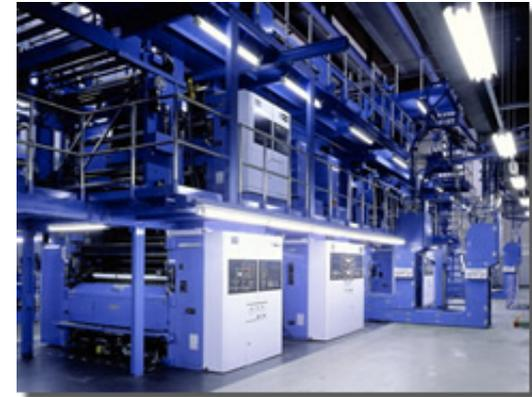
図30-10 新聞用オフセット輪転機(東京機械製作所)
