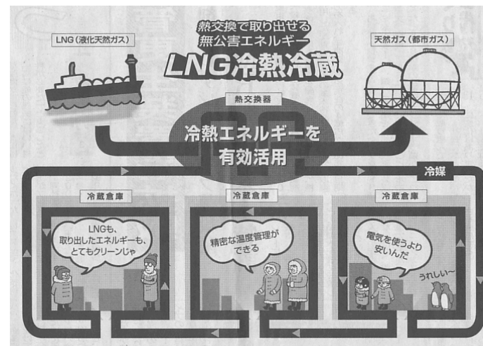
図25-9 LNG利用冷凍倉庫
