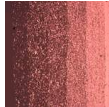
図23-10 傾斜機能材料 (セラミックス-金属系傾斜機能材料は耐熱性と強度特性を兼ね備えた材料)
