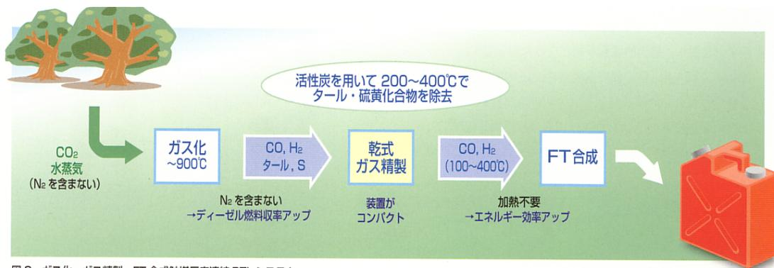
図2 ガス化・ガス精製・FT合成触媒反応連結 BTL システム
