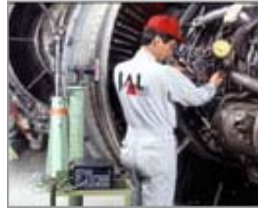
図16-25 ボアスコープによるエンジン内部検査
