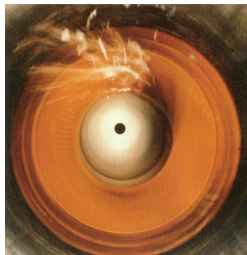
図16-19 鳥吸い込み試験
