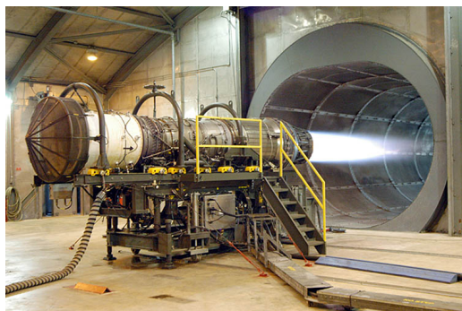
図16-18 ベンチエンジン試験 (アメリカ・ロビンソン空軍基)
