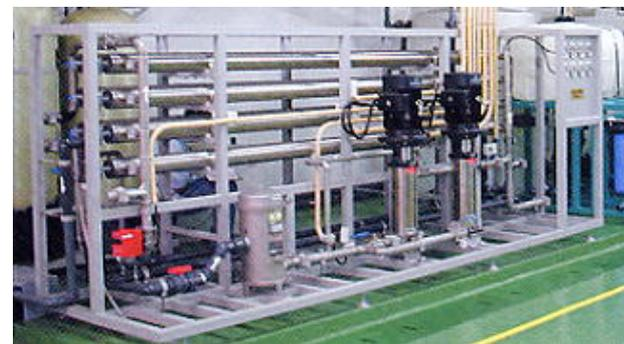
図14-6 逆浸透膜(RO膜)ろ過装置
