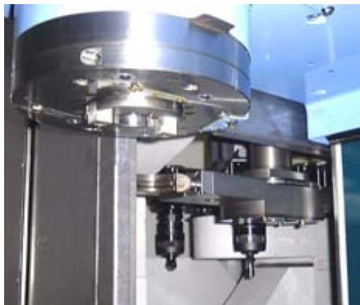
手前には工具が取り付けられていない主軸とATCアームが、その奥にはツールマガジンに収納されたメントリカッタとエンドミルが見えている。工具交換時にはATCアームが180度回転し、主軸に保持されている工具をツールマガジンに収納されている工具と交換する。
