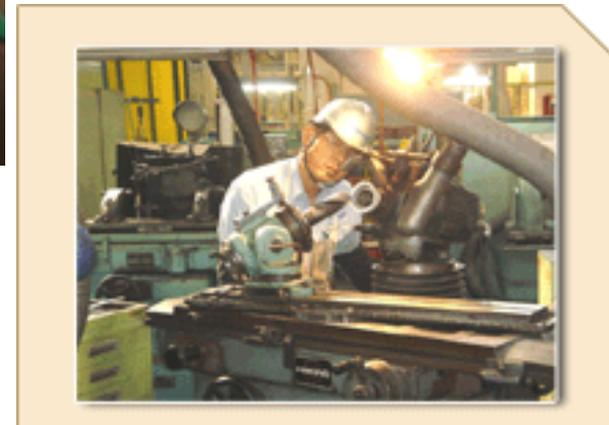
図13-19 万能研磨盤での作業状況
