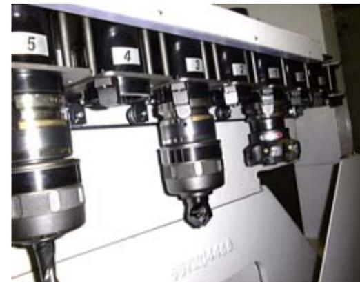
工具は番号のついたツールポケットに収納されている。必要に応じて主軸への取り付けを行うために、あらかじめ次の工具が交換位置に移動される。通常この動作は前の工具で加工が行われている間に完了するようになっている。写真の工具は手前からエンドミル、メントリカッタ、フェイスミル。
