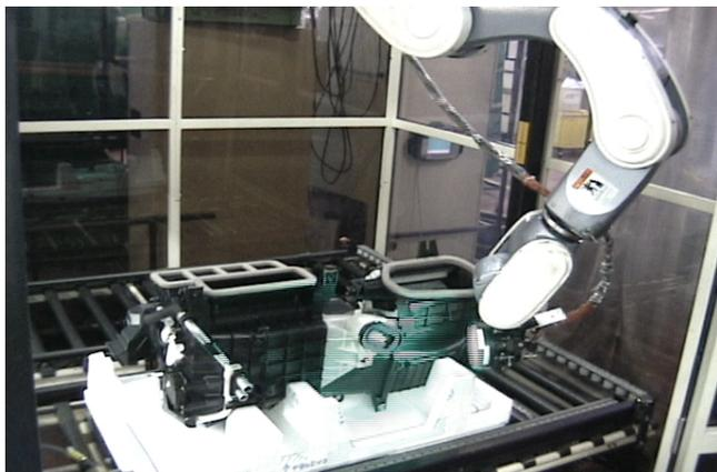
図12-22 高速検査ロボット
