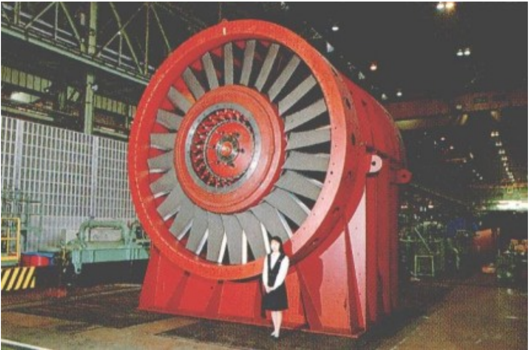
参考図6-3 ボイラファン
