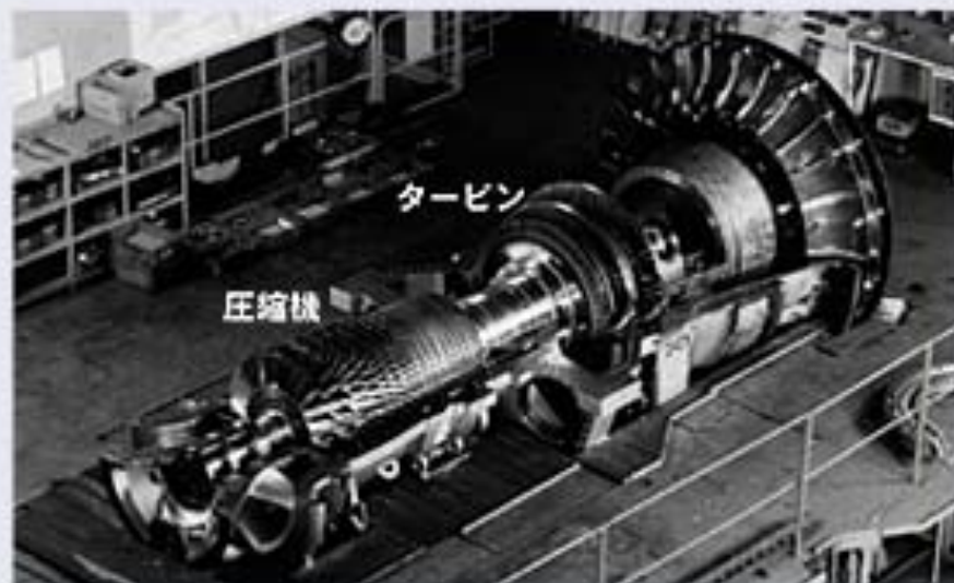
(b) H-25 ガスタービン(出力：25MW，入口ガス温度：1,260℃)
