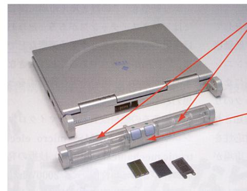
汎用ボトルと同じ素材でできた交換式の燃料パック
